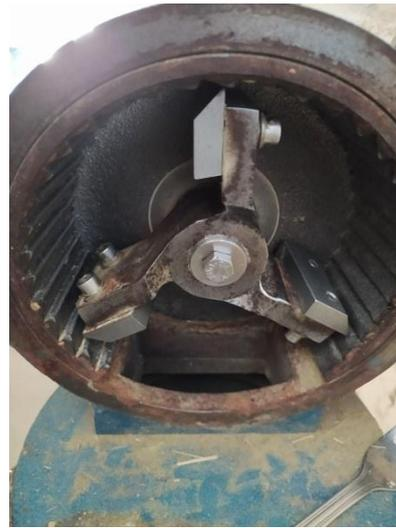
Afin de permettre un broyage correct nous avons apporté une grille à 1 mm du broyeur Retsch SM100 du Cirad à Montpellier pour l'adapter au broyeur Retsch SK1 présent à l'IREC pour essayer de corriger ce problème de granulométrie. Point de vigilance, la grille tamis a un sens, ne pas se tromper lors de la mise en place dans le broyeur.
