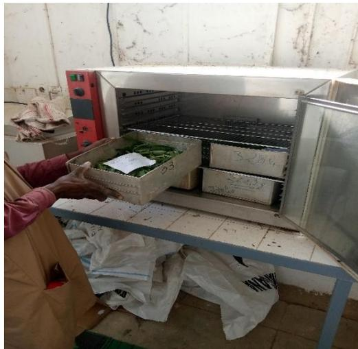
*Photo 6: Etuve à séchage d'échantillons*
