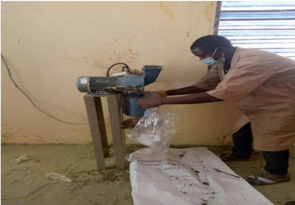
Photo 8: Passage de l'échantillon au moulin (Broyage)
